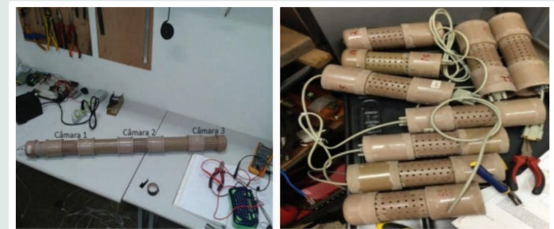
As sondas foram introduzidas na massa de grãos no momento do enchimento do silo (Figura 2). As aberturas realizadas no silo para colocação das sondas foram devidamente fechadas e vedadas com fita especial.
