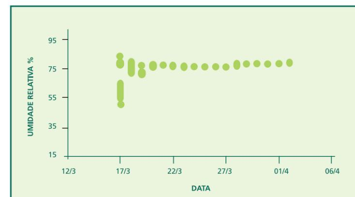
Figura 9. Umidade relativa do ar intergranular da soja úmida armazenada em silo bolsa. Sinop-MT, 2015
