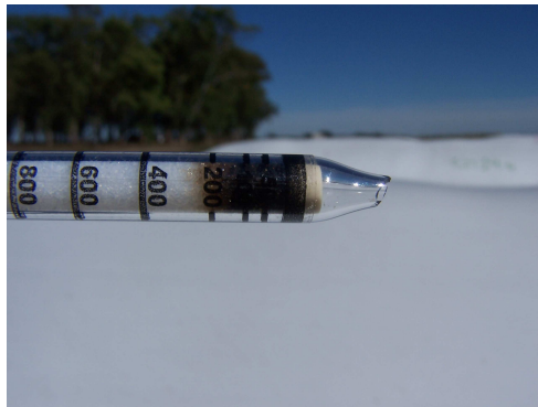
Figura 2. Detalle de una ampolla de medición donde se observa la marca de 200 ppm de concentración de fosfina.
