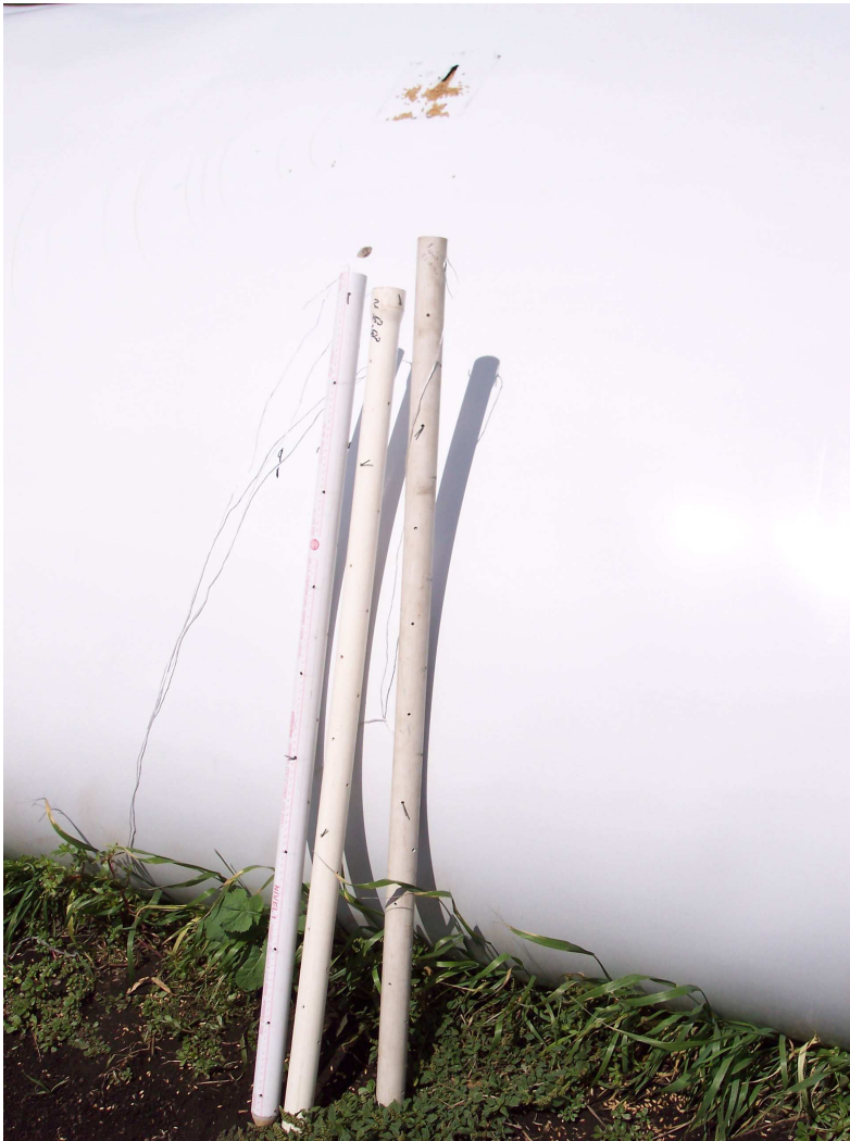
Figura 5. Detalle de los caños conteniendo los tubos con insectos en su interior. Se puede observar la perforación de los caños y el corte en la bolsa por donde se introdujeron los caños.
