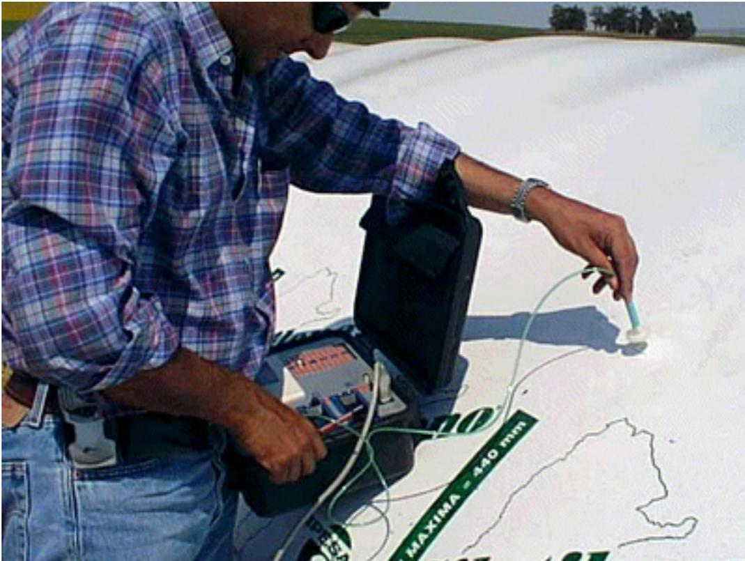
Figura 8. Determinação da concentração de O<sub>2</sub> e CO<sub>2</sub> no interior das bolsas.
