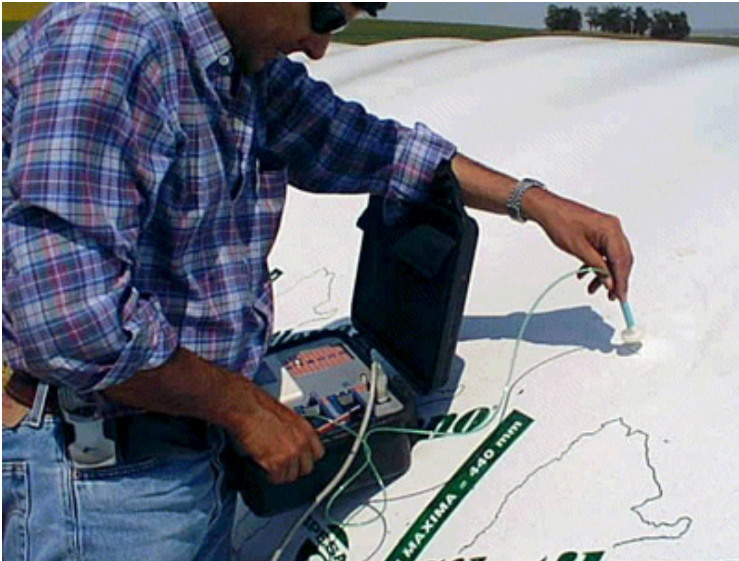
Figura 8. Determinação da concentração de O 2 e CO 2 no interior das bolsas.
