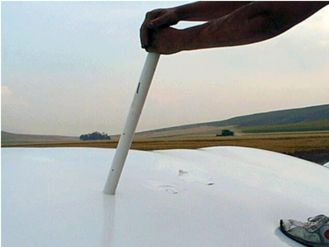
Figura 9. Colocação dos tubos contendo celas com insetos vivos no interior das bolsas.
