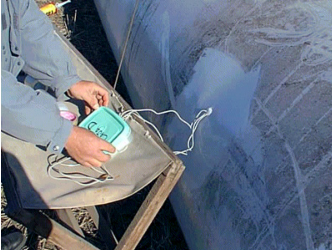
Figura 7. Instalação da caixa hermética contendo os dataloggers para a coleta de dados de temperatura.
