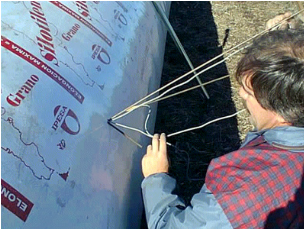
Figura 6. Instalação de sensores de temperatura no interior das bolsas. Cada uma das varinhas corresponde a uma localização dentro da bolsa (superior, média e inferior).
